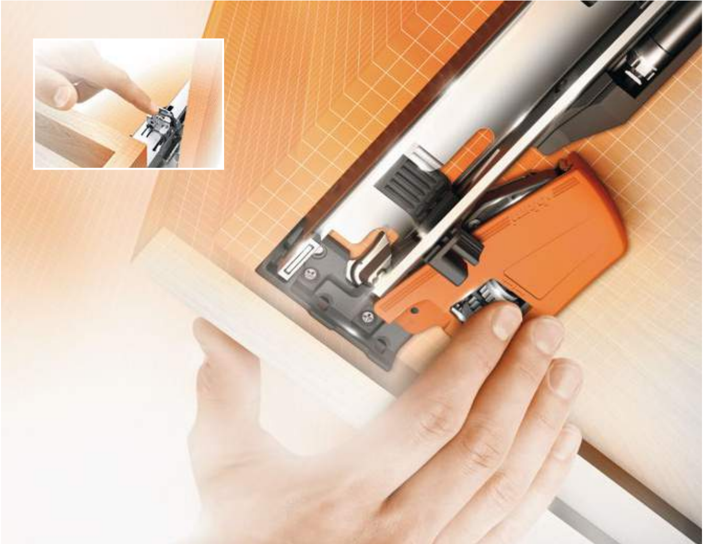
1 Регулировка по ширине осуществляется с помощью замка; при необходимости можно произвести корректировку смещения продольной оси ящика с помощью механизма, расположенного на правой направляющей сзади.
