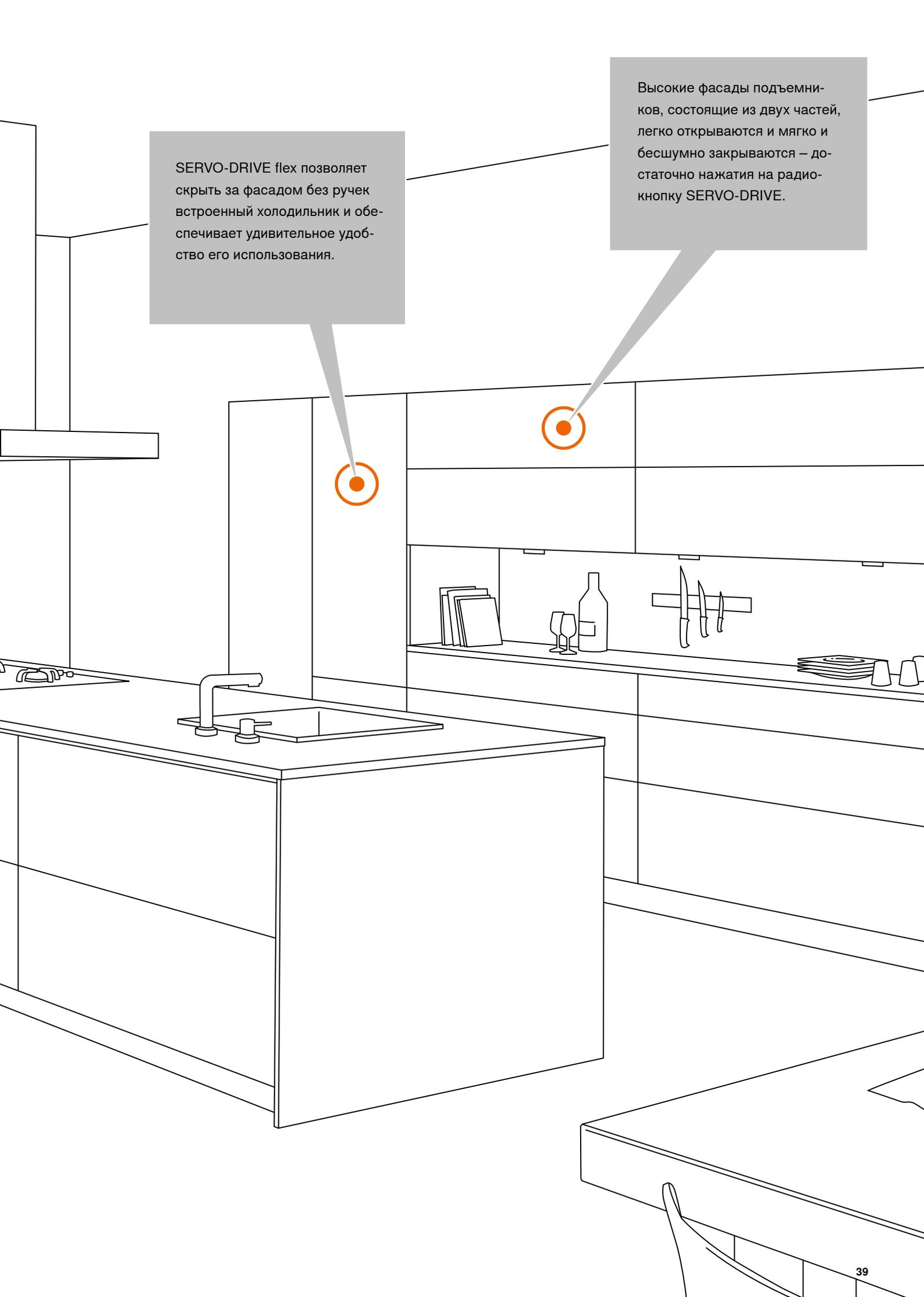
SERVO-DRIVE flex позволяет скрыть за фасадом без ручек встроенный холодильник и обеспечивает удивительное удобство его использования.
